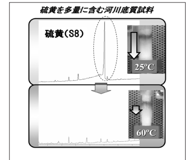
図2 加熱処理による精製効果(硫黄化合物除去効果)
